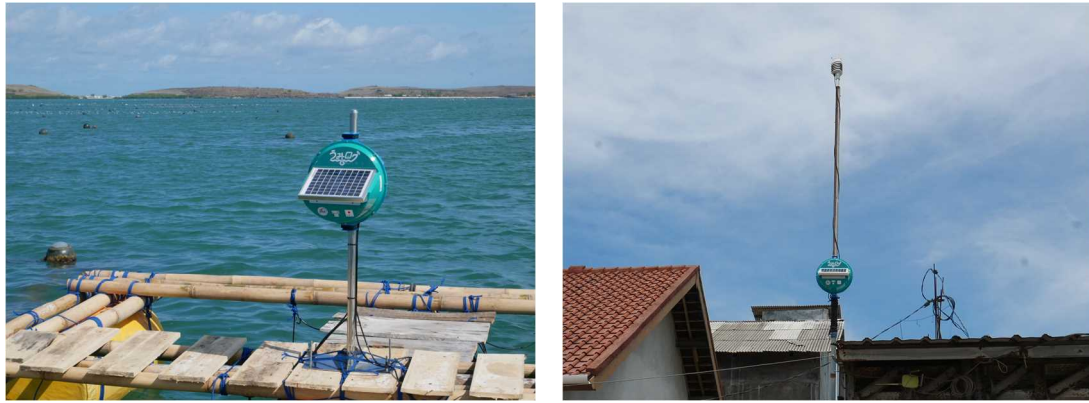
図 2-9 Lombok に設置した廉価版のセンサノード
