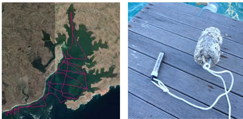
図 2-10 Seruwe 湾での深浅測量の航跡（左）と潮位観測に用いた水位計（右）
