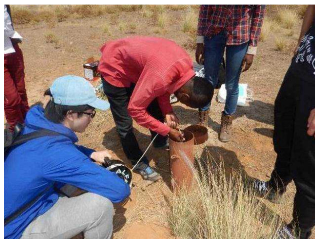
Kabwe のモニタリング井戸からの採水
