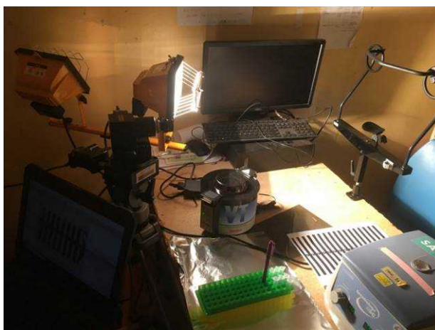
ストロボ光源での暗室内の撮影。左の光源手前がハイパースペクトルカメラ
