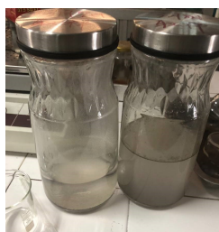
図 22 (左) バイオガソリン製造試験、(中・右) バイオガソリンの外観 (中：製造直後、右：油水分離状態)
