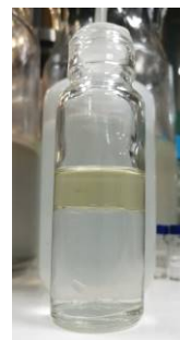
図 22 (左) バイオガソリン製造試験、(中・右) バイオガソリンの外観 (中：製造直後、右：油水分離状態)
