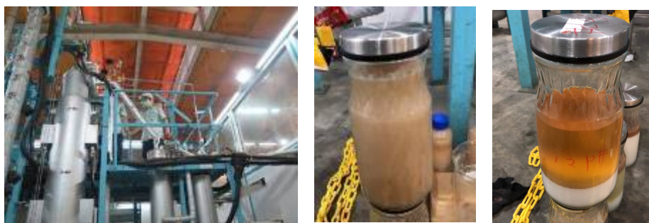
図 21 （左）バイオ軽油製造試験、（中・右）バイオ軽油の外観 （中：製造直後のエマルジョン状の状態、右：精置分離後）
