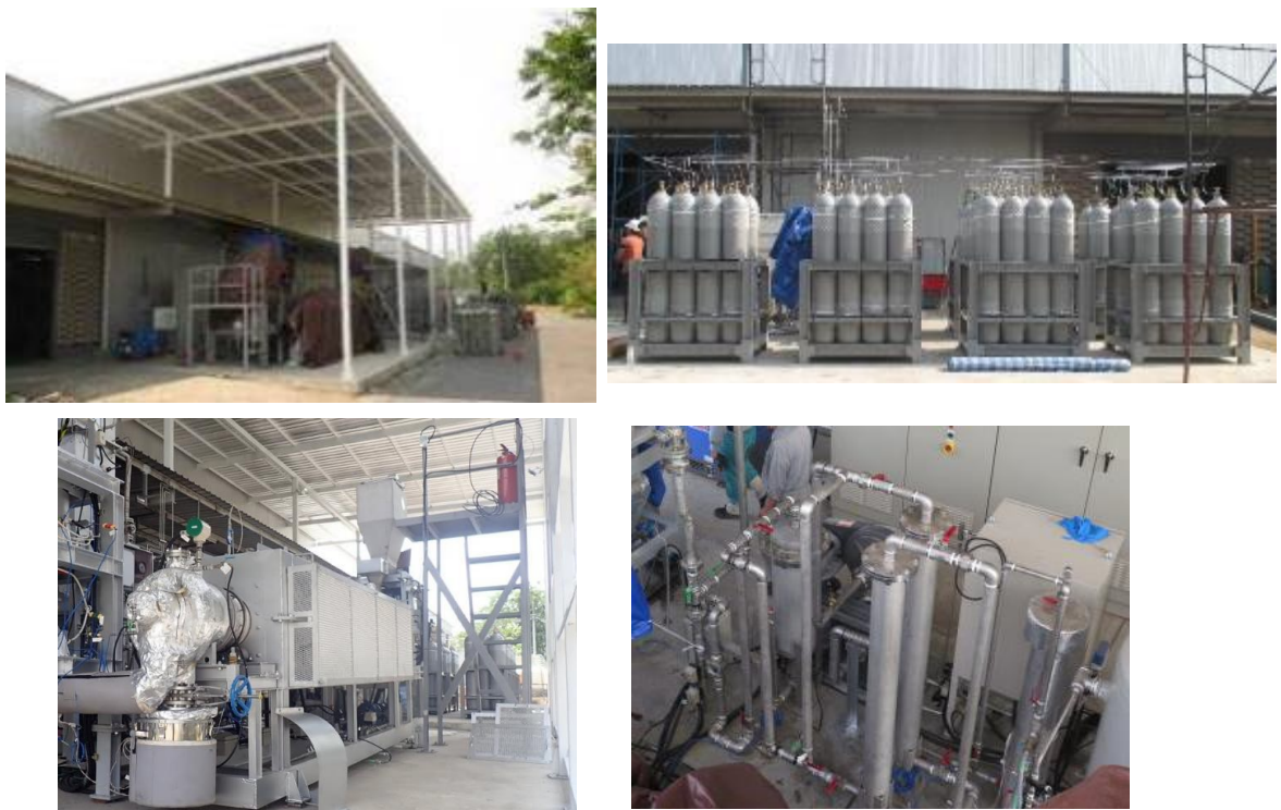
図 8 （上左）供与機材（バイオマスガス化ベンチ装置） （上右）ガス貯留 （下左）ガス化炉 （下右）ガス精製工程
