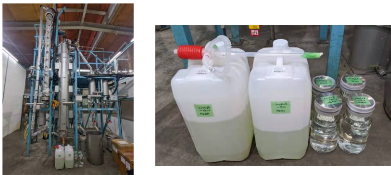
図 23 (左) バイオメタノール製造設備、(右) バイオメタノール
