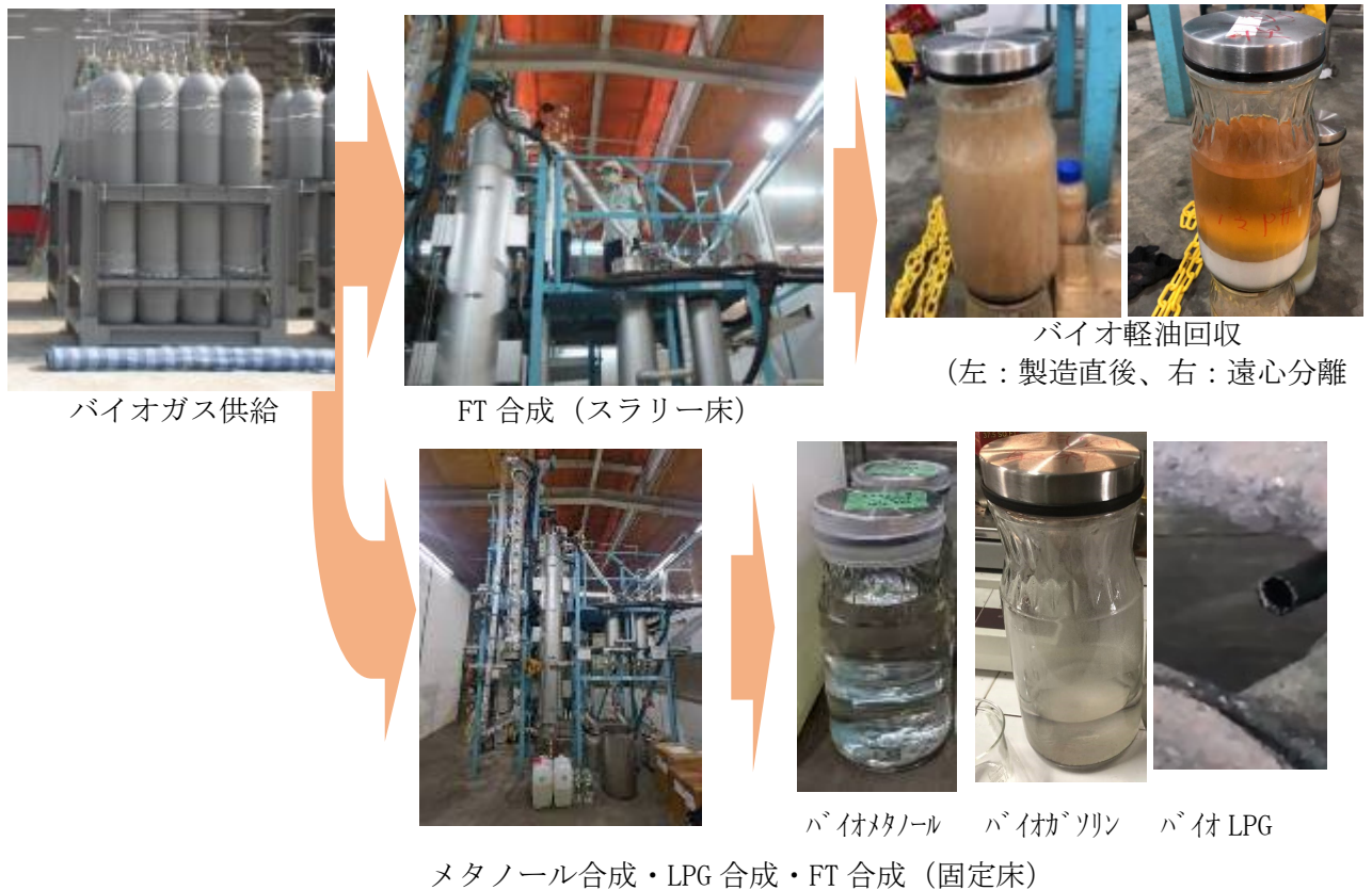
図 20 (上) バイオ軽油製造、(下) バイオメタノール・バイオ LPG・バイオガソリン製造
