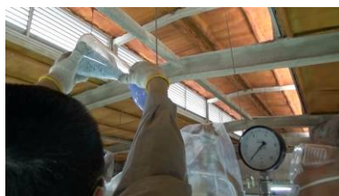
図 22 (左) バイオガソリン製造試験、(中・右) バイオガソリンの外観 (中：製造直後、右：油水分離状態)
