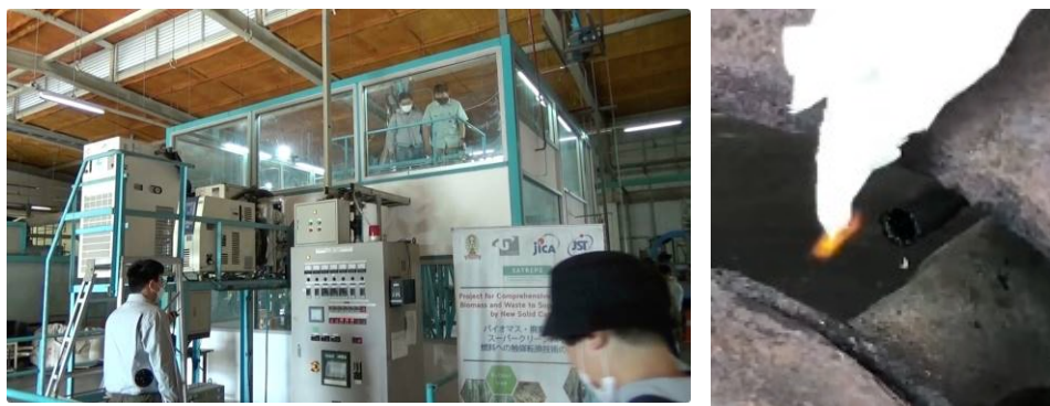
図 24 (左) バイオ LPG 製造試験、(右) LPG 燃焼の確認
