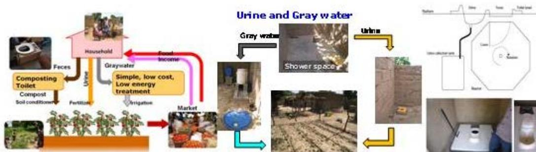
図—2 途上農村モデル(左からコンセプト, 尿と雑排水システム, コンポストトイレ)
