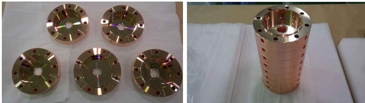
製作したミュオン専用円筒装荷型加速管（左:全体積み上げ接着前、右:接着後）
