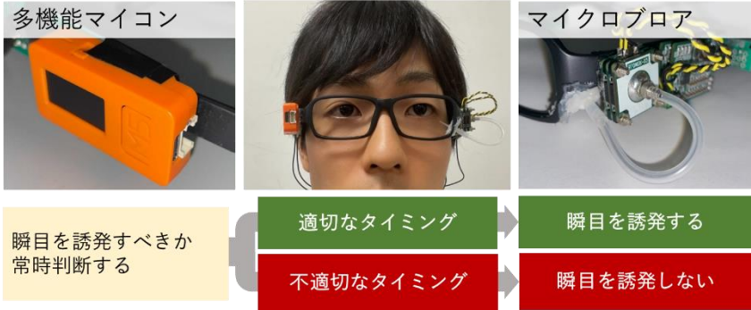
図 2 適切なタイミングで瞬目を誘発させる眼鏡型デバイス
