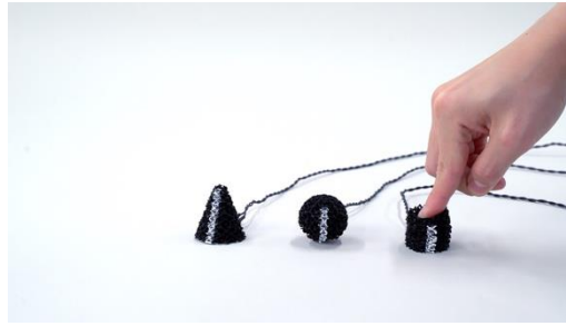
図 1. 3D プリンタによる柔らかいセンサの作製手法
