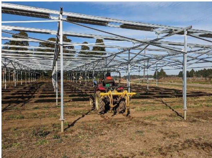
図5 ソーラーシェアリング農地におけるスマートアシスト機能実証テスト
