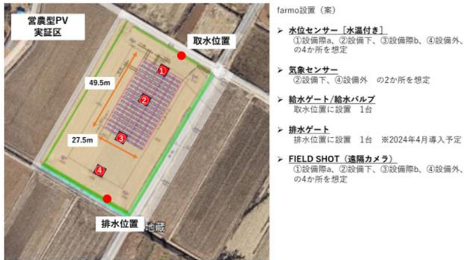
図1 水田ソーラーシェアリングへのセンシング機器設置計画
