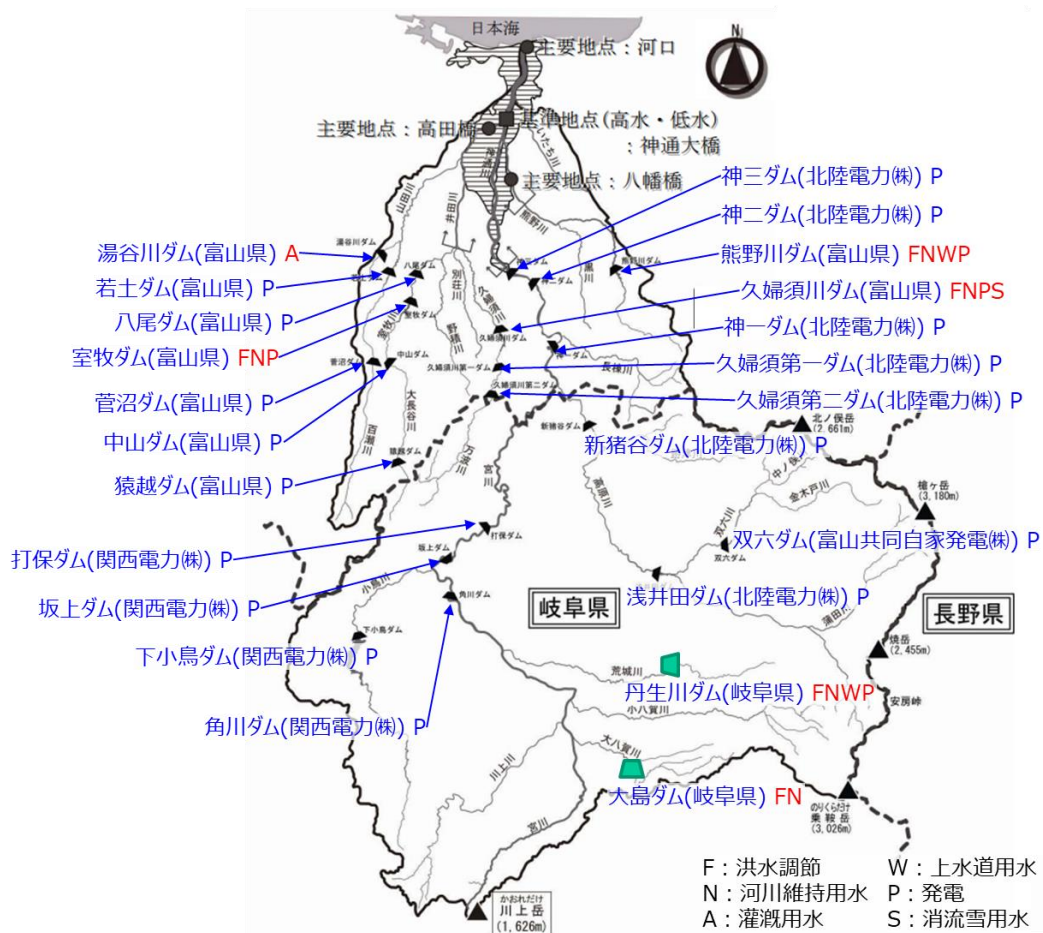
図-2：神通川流域に設置されているダムとその目的。なお、大島ダムは未完成である。
