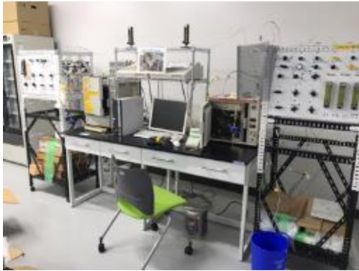
図 1. 若い地下水滞留年代対応の測定システム (SF 6 、CFCs) の整備。琉球大学農学部へ導入。
