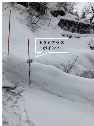
積雪時の5Gアクセスポイント通信実験風景 新潟県松之山温泉地区 2024年1月25日
