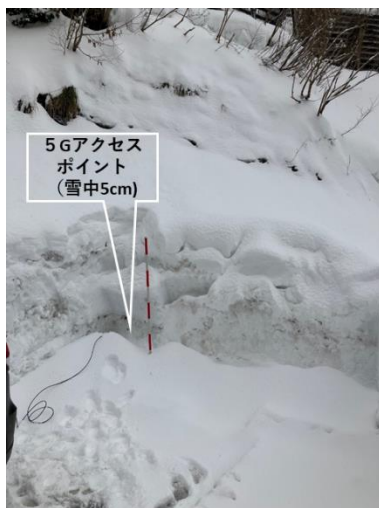
積雪時の5Gアクセスポイント通信実験風景 新潟県松之山温泉地区 2024年1月25日
