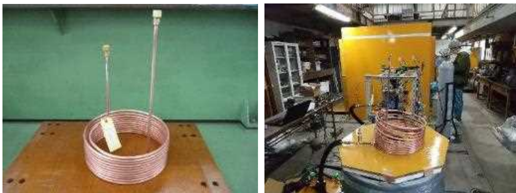
図3 銅製丸巻きコイルの外観写真
