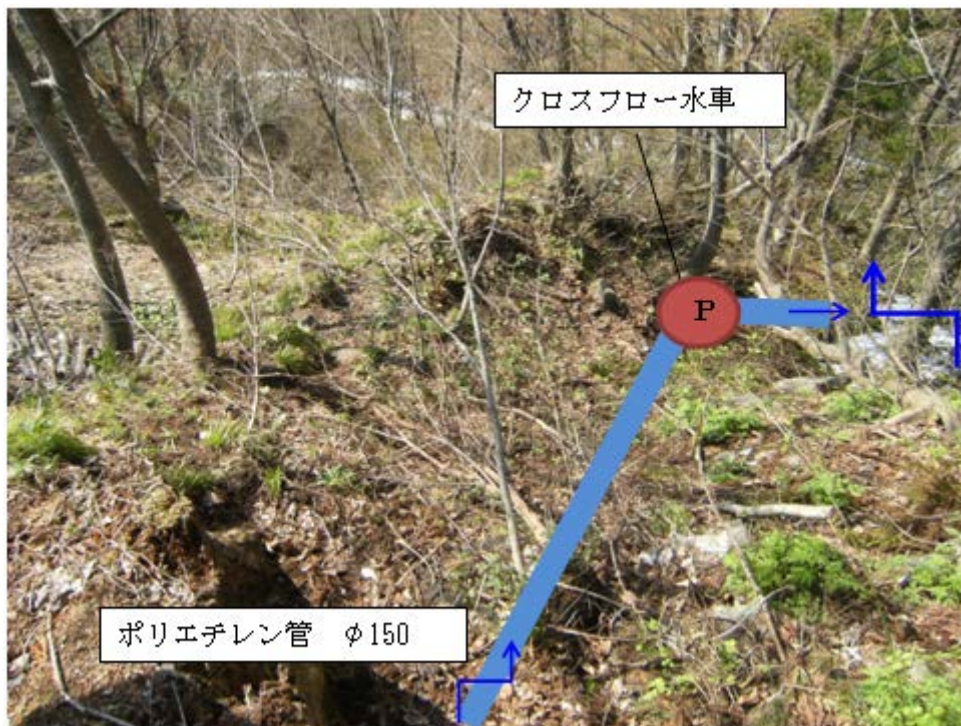
図表8 配管ルート図 (崖上から撮影)
