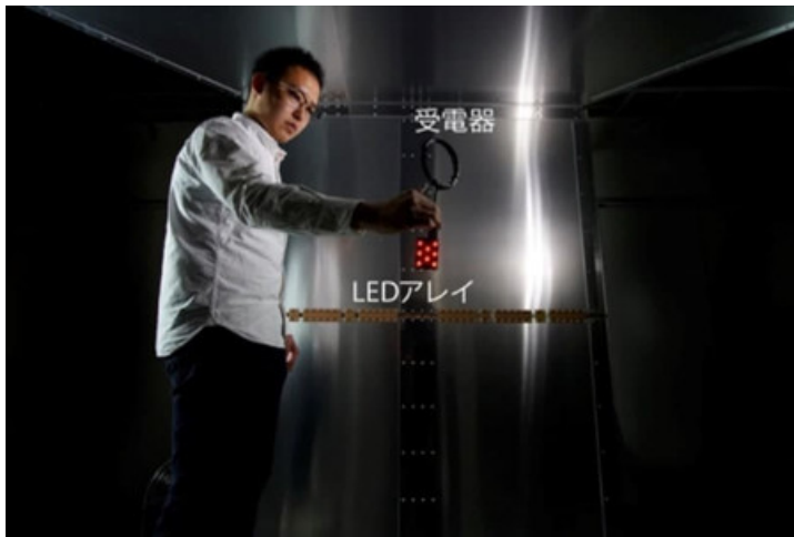
(左) マルチモード QSCR の内部 (駆動中のため LED アレイ が点灯) (右) マルチモード QSCR を用いた場合の電力伝送効率のグラフ
