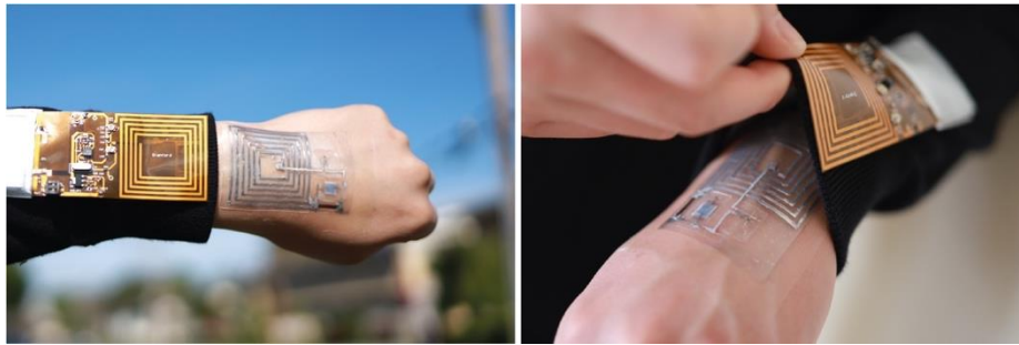
図2. ワイヤレスで駆動できる伸縮性センサ・ディスプレイシステム。
