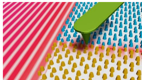
図 1. 実現したトポロジカル音響導波路の概念図。赤と白の縞々が GHz の表面弾性波を示し、その伝搬の様子をカンチレバー（緑）で直接可視化している。
