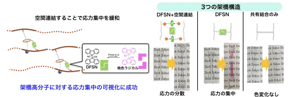
図 5. 力学応答性分子骨格 DFSFN を用いた架橋点にかかる応力の可視化
