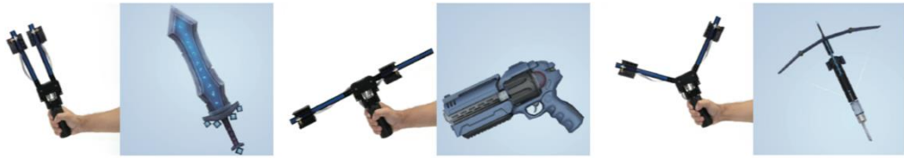
図1 質量特性の制御によってCGと一致した形状知覚を作り出す装置“Transcalibur”
