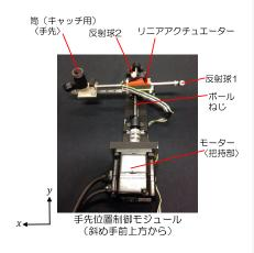
である. 制御方法としては、本モジュールに設置した反射球を高速(1 kHz)にトラッキングすることにより、本モジュールの手先位置をリアルタイムに計測することができ、その位置情報をコントローラにフィードバックし、各アクチュエータを駆動させることにより、目標値に対して高速な視覚フィードバック制御が可能である.
