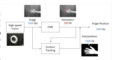
で補完するものである. これにより, マーカー等を用いることなく, 多少背景が乱雑な場合にもロバストかつ高速に指先をトラッキングすることに成功した. また, CNN 単体よりも高い精度で指先位置を計測できることを確認した(右表). 加えて, 低速な手の運動を精確に捉えるために, 画
