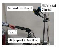
置・姿勢を高精度で計測する手法を提案している。次に、その計測した板状物体の位置・姿勢からロボットハンドの逆運動学を解き、ロボットハンドの各関節角度を高速かつ高精度に制御することにより、人間の操作に瞬時に対応できる動作を実現した。この制御方法において、従来は人間のロボットのダイナミクスモデルが必要であったのに対して、今回は幾何学的な計算のみで実現できる点が独創的な特徴として挙げられる。
