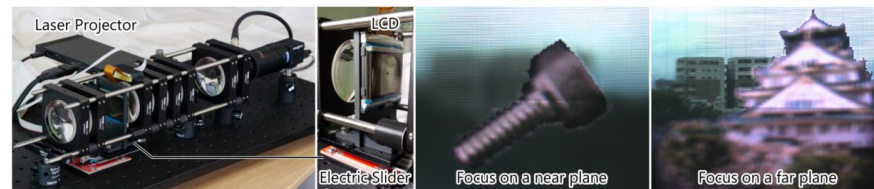
図:提案した光学遮蔽技術を組み込んだ光学シースルーHMD のデモ
