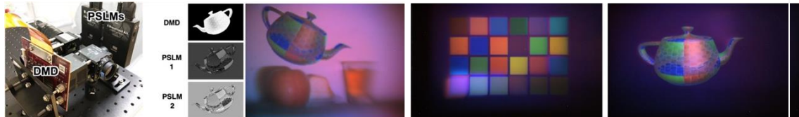
図:色再現性とコントラストが大幅に改善した光減算ディスプレイ(ティーポットとマスクパターンがヴァーチャルな映像)
