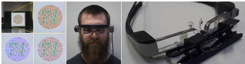
図： ChromaGlasses, 2018.色覚を補助する映像を視界に重畳する。
