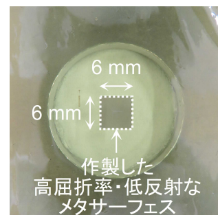
図2 3THz帯の高屈折率・低反射な極限屈折率材料
