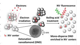
5: https://www.qst.go.jp/site/press/26372.html)。これにより、5 nm の爆轟法ナノダイヤモンドの量子センサーとしての利用に活路を見出した。また、爆轟法ナノダイヤモンドについては生体親和性向上のための表面化学修飾法の開発にも取り組んでいる。その副次的な結果、表面化学修飾状態を厳密に調整した爆豪法ナノダイヤモンドを用いたある種のコンポジット材料が耐湿性水素分離膜として極めて有望であることを実証するなど、当初は思いもよらなかった研究成果にもつながった(Huang et al., Nature Energy, in Press; プレスリリース1)。
