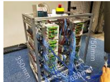
図3. 二次圧計測可能 64ch 制御器 (同サイズ内に 96ch 分収納可)
