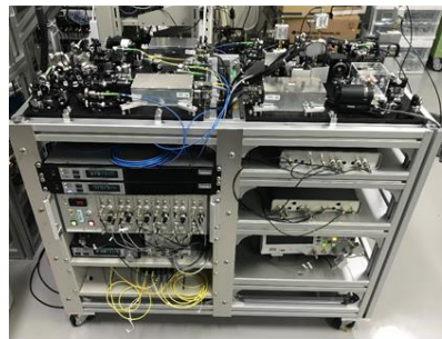
図 4: トリウムイオンレーザー冷却用光源。(左) 3 色すべてのレーザー光源が搭載された光源ステーション。(右)レーザー光源構成図。
