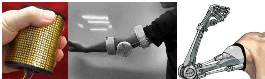
図 5 (左)電気触覚を用いた手掌部全体への触覚呈示 (中、右) 関節部への触覚呈示による運動感覚および身体感覚改変
