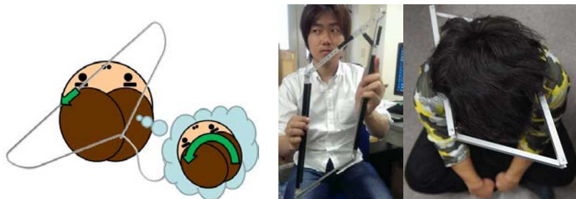
図1 (左) ハンガー反射の機序 (右) 剪断変形を生じさせる装置 この解明された機序に基づき、身体他の部位でも同様の現象が生起することを確認した
