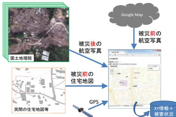
図4 各種のクラウドサービスを統合した災害対応過程での空間情報付与システム概要
