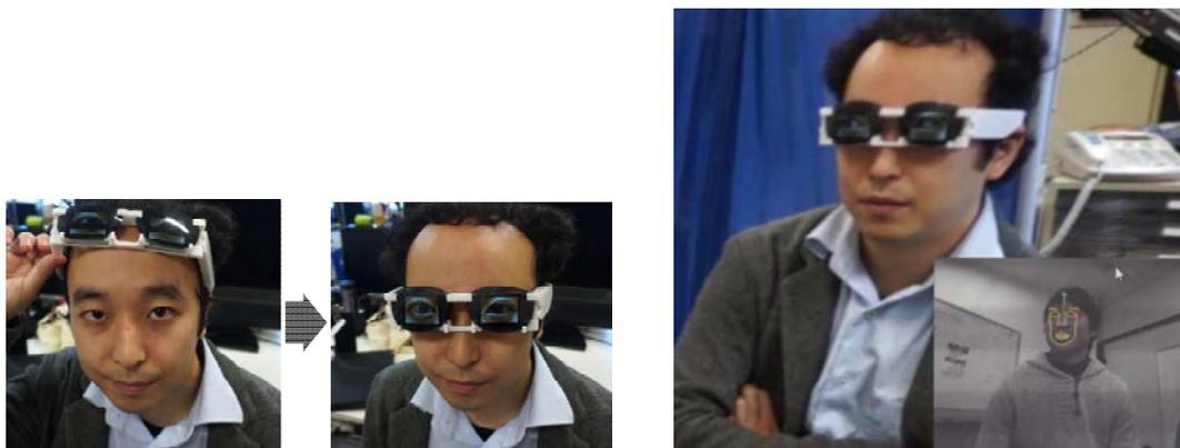
図 10::AgencyGlass による人間の擬人化と感情表現の自動化(左: 擬人化表現の装着の様子 右: 外部カメラと連動させ、ユーザの向いた方向に視線を向けた例)
