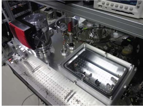
に光学定盤のように 25mmピッチでM6 ねじが切っている板を内包した角型真空槽を設計し(写真参照), この中で6枚構成のbow-tie共振器を組んだ。レーザーの共振器長と真空槽内の外部共振器長が完全に一致した時のみ共振器内に光強度が蓄積・増強される。下左図はその様子を示している。レーザー共振器の共振器長を掃引し, 共振器鏡から漏れてくる光強度によって共振器内強度を得ている。両方の光学長が一致した時のみ共振器内強度が劇的に上昇するのが見える。また, 自作したEOMを利用して, 繰り返し周波数を共振器に合わせるためのエラー信号を取得し, 安定にパルスを光共振器にロックすることに成功した。結果共振器内で330倍のパルス強度(平均強度 150W相当)を得た。この平均強度で, 繰り返し周波数 112MHz, 焦点でのビー
