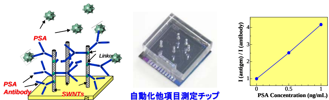
図10 CNT 電極を使ったタンパク質の非標識検出
