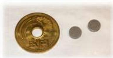
図 4 非蒸発型ゲッター材 (NEG)
