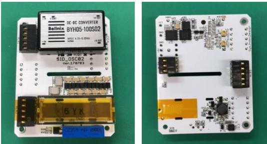
図 3.3.8. 「細菌 1 細胞アレイ」細菌細胞破碎用電源基板とその仕様。
