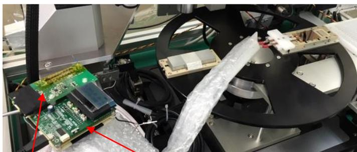
図 3.3.3. 「細菌 1 細胞アレイ」電極基板 (左) と試作 1 号機用の遠心廃液装置 (右)。
