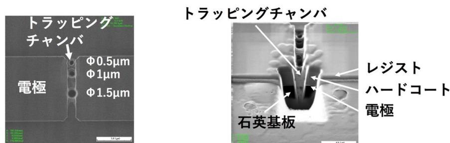
直径0.2 μm程度までのチャンバを位置合わせの上で作製可能
