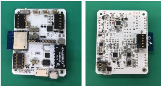
図 3.3.7. 「細菌 1 細胞アレイ」細菌捕捉用電源基板とその仕様。
