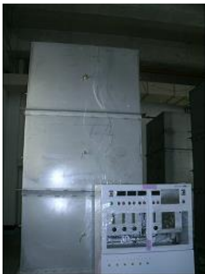
写真 1 パイロットスケール土壌浸透リアクター
