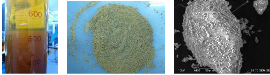
図 3-1-6 バイオマス(クリーニングクローブ)からのリン・カリウム同時回収.(左:抽出液と生成した沈殿、中:PK 回収物、右:回収物の SEM 画像)
