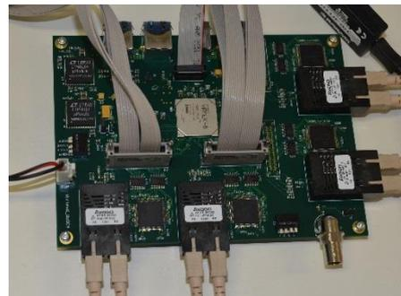
図 3-7：開発した FPGA ボード
