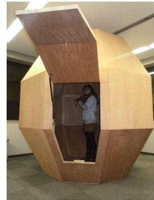
図 3-1: 開発した音響樽の初期モデル
