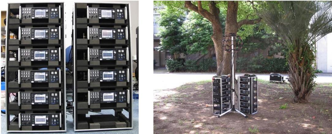
図 3-10：可搬型データレコーダによる 80 チャンネル収録システムと屋外での収録の様子
