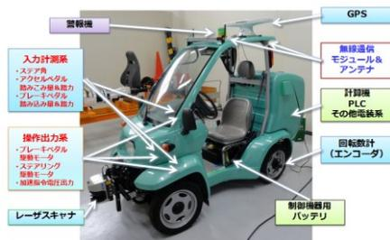
図 3-8. 実験に用いた改造小型電気自動車
