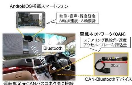
図 3-4. CANBUS 信号収録システム
