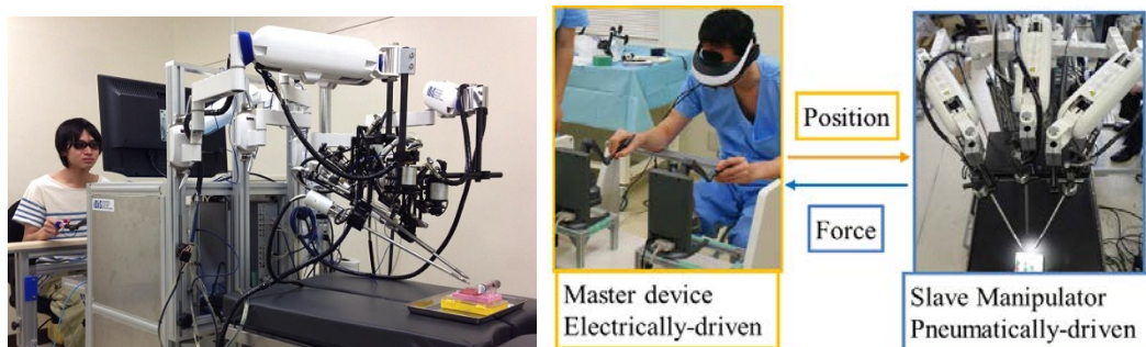
図 3.2.6 試作した力覚提示機能を有するマスタ・スレーブ型手術支援ロボットシステム
