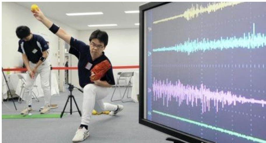
図6: 筋電の可聴化によるスポーツ上達システム
