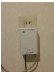
電力測定装置
