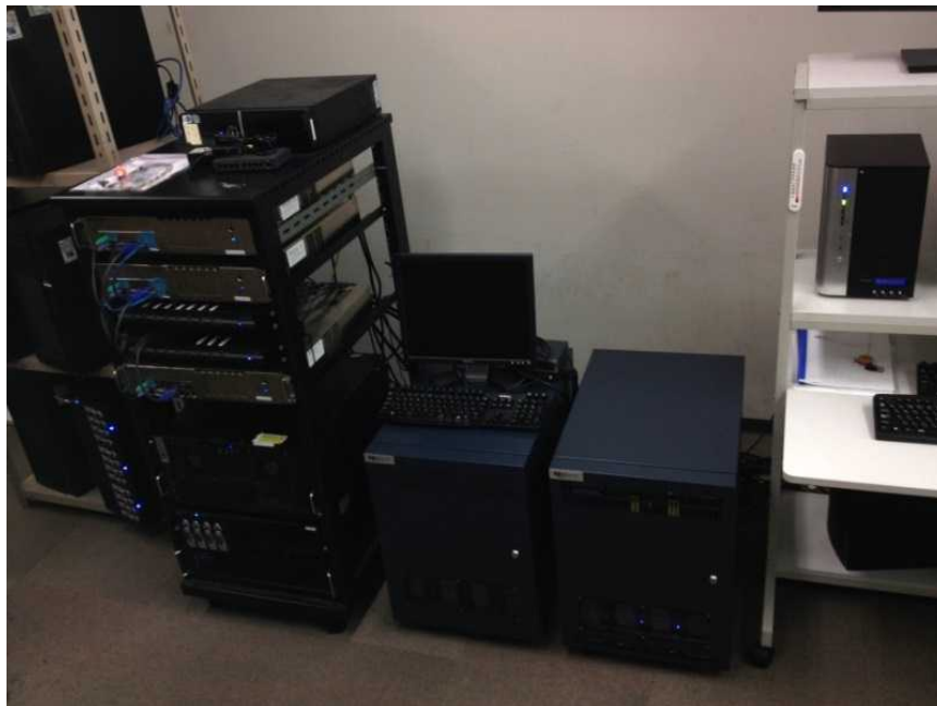
本研究で構築した森西グループクラスター計算機およびファイルサーバ。
