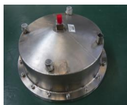
図 16 2.45 GHz 帯均一マイクロ波照射容器
