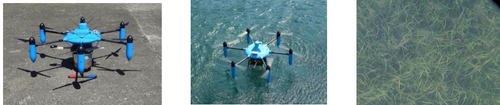
図 3.3.7 陸上(左図)および着水モード(中図)のマルチコプター搭載ハイパースペクトルセンサと佐渡白瀬地先で着水モードにより計測した可視画像(右図)
