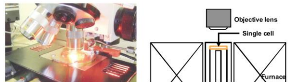
図 40 高温電気化学その場ラマン分光測定装置
