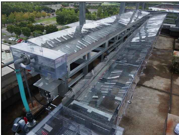
写真3 東京大学柏キャンパスの生命棟屋上に設置された150Lタイプの屋外大量培養装置、雨天でも運転できるようフード付きになっている。遠景から屋上であることがわかる。
