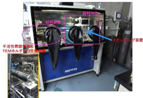
図 28. 不活性雰囲気対応 TEM 観察試料作製システム
