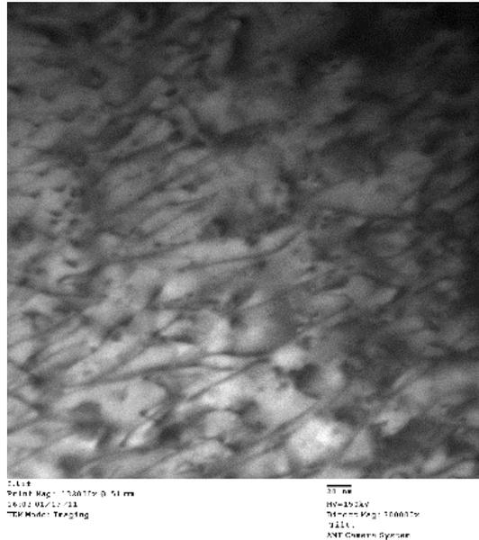
図 20 高密度格子欠陥導入されたアルミニウムの透過電子顕微鏡像
