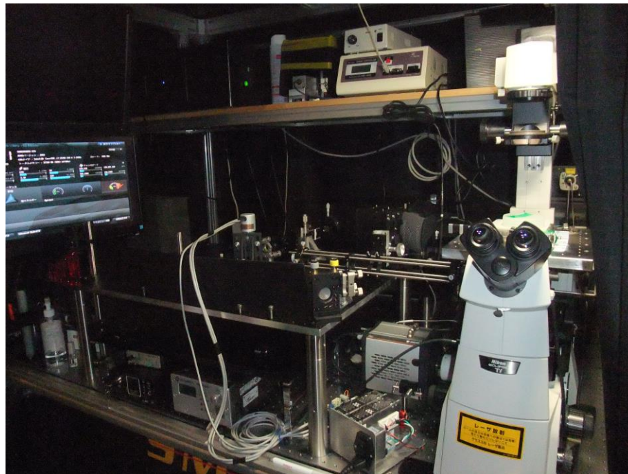
本 CREST で導入したラマンイメージング装置
