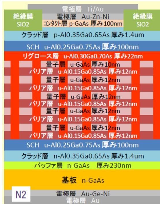
図 39 試作した GaAs/AlGaAs 量子ドット LED 構造
