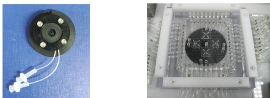
図3マイクロ流路化された单一チャンネル素子(左)と20チャンネル素子[右]
