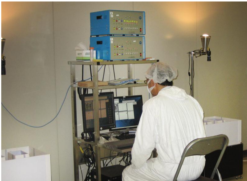
行動解析を実施中の様子。T字型迷路(左右の白色の装置)内のマウスの行動をコンピューターに取り込み解析を行う。青色の箱形の機器はT字型迷路の制御装置。
