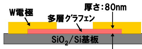
図2(b) W電極を用いた抵抗評価パターンの断面模式図
