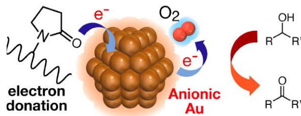
図 G-3 Au:PVP による溶存酸素の活性化と酸化触媒の機構
